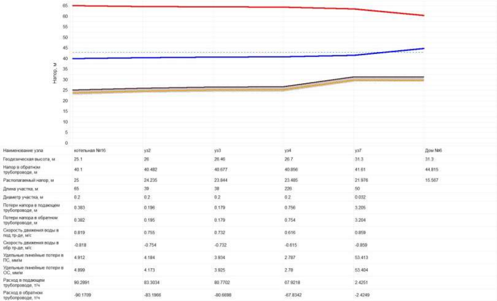
Рисунок 5.5. Перспективный пьезометрический график тепловых сетей СО до ул. Центральная д.6.
